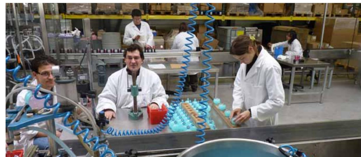
La chaîne de production est en partie automatisée, lorsque l'eau de toilette est classique. En effet, pour des parfums plus spécifiques avec des paillettes par exemple, le flaconnage se fait manuellement. Les fonctions automatisées sont le nettoyage du flacon, le remplissage, le sertissage du vaporisateur et l'impression de celui-ci au jet d'encre (garantie de la traçabilité du produit).
